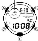
La luz de fondo utiliza un panel EL (luz electroluminiscente) que ocasiona que la pantalla entera se ilumine para una fácil lectura durante la oscuridad. El interruptor de luz automático ocasiona que la luz de fondo se active cuando el reloj es inclinado en ángulo hacia su cara.
