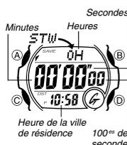
Le chronomètre permet de mesurer le temps écoulé, des temps partiels et deux arrivées.
