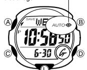
Le rétroéclairage emploie un panneau EL (électroluminescent) qui éclaire tout l'écran pour que l'affichage soit mieux visible dans l'obscurité. L'autocommutateur d'éclairage de la montre éclaire le rétroéclairage lorsque vous tournez la montre vers votre visage dans l'obscurité.
