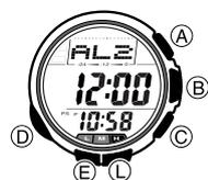
1. En el modo de alarma, utilice **C** y **A** para desplazar a través de las pantallas, hasta visualizar la alarma cuya hora desea ajustar.
