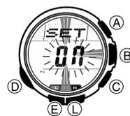
1. En el modo de barómetro/termómetro, mantenga presionado E hasta que SET aparezca en el área de presentación superior.
