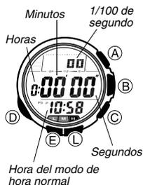
El cronógrafo le permite medir el tiempo transcurrido, tiempos fraccionados y dos llegadas a meta.
