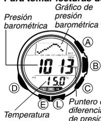
Presionando B en el modo de hora normal o en cualquiera de los otros modos de sensor ingresa el modo de barómetro/termómetro y automáticamente inicia la medición de presión barométrica y temperatura.
