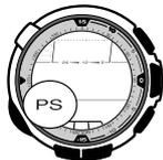
Cuando se activa la alimentación, la función de ahorro de energía automáticamente coloca el reloj en la condición de letargo, siempre que se lo deja en un lugar que está oscuro durante un cierto período de tiempo. La tabla siguiente muestra la manera en que son afectadas las funciones del reloj por la función de ahorro de energía.
