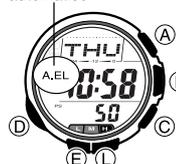
La presentación del reloj se ilumina mediante un panel EL (electroluminiscente) para una fácil lectura en la oscuridad. El interruptor de luz automático del reloj, activa automáticamente la iluminación cuando inclina el reloj hacia su cara.
