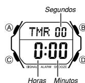
O timer pode ser definido dentro de uma faixa de um minuto a 24 horas. Um alarme soa quando a contagem regressiva atinge zero.
