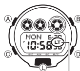
Indicateur de commutateur d'éclairage automatique en service
