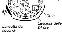
Lancetta delle ore Lancetta dei minuti Lancetta dei secondi Lancetta delle 24 ore Data
