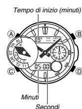
È possibile impostare il timer per il conto alla rovescia nella gamma compresa fra 1 minuto e 60 minuti. Quando il conto alla rovescia giunge a zero, una suoneria suona.
