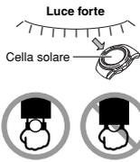
L'elettricità generata dalla cella solare dell'orologio viene accumulata da una pila incorporata. Se si lascia o se si usa l'orologio in luoghi in cui esso non è esposto alla luce, la pila si scarica. Accertarsi che l'orologio sia esposto il più possibile alla luce.
