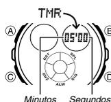
O timer pode ser definido dentro de uma faixa de um minuto a 60 minutos. Um alarme soa quando a contagem regressiva atinge zero. O timer também tem uma função de repetição automática e um gerador de bipes que sinaliza o progresso da contagem regressiva.
