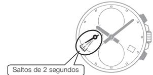
**Si el movimiento normal de la manecilla no se reinicia después de cambiar la pila**
