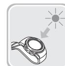
Cuando lleve puesto el reloj, asegúrese de que la manga no bloquee la pantalla (panel solar). La eficiencia en la generación de energía se reduce incluso cuando la pantalla del reloj está bloqueada parcialmente.
